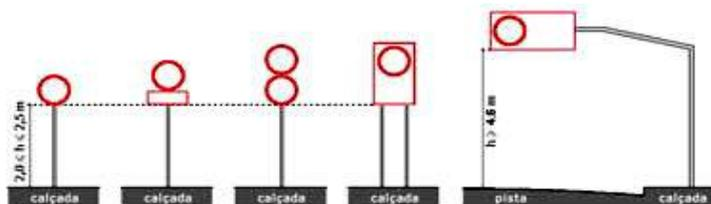
O afastamento lateral das placas, medido entre a borda lateral da mesma e da pista, deve ser, no mínimo, de 0,30 metros para trechos retos da via, e 0,40 metros nos trechos em curva.
